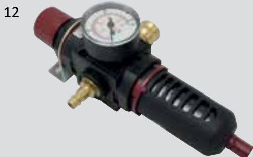
Filterregler G3/8 mit Filterdruckregler, Manometer, Kunststoffschutzkorb, Befestigungswinkel, Stecknippel G3/8 und Schnellschlusskupplung
