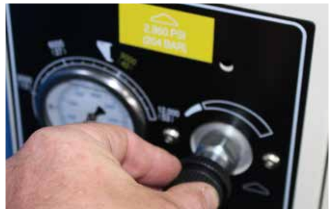
Einstellung der Einpresskraft / Setting of the clinching force
