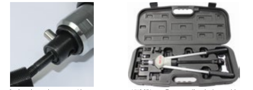
Système de remplacement rapide pour mandrin fileté.
