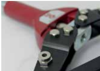
Wechselmundstücke im Werkzeug verschraubt
