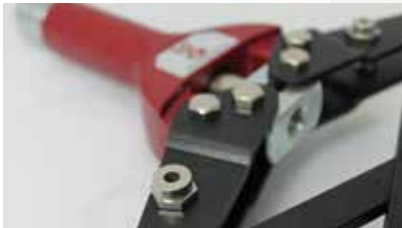
Wechselmündstücke im Werkzeug verschraubt.
