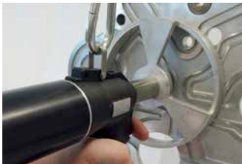
Accessoire spécial adaptateur angulaire pour le respect de la perpendicularité nécessaire par rapport au composant.
